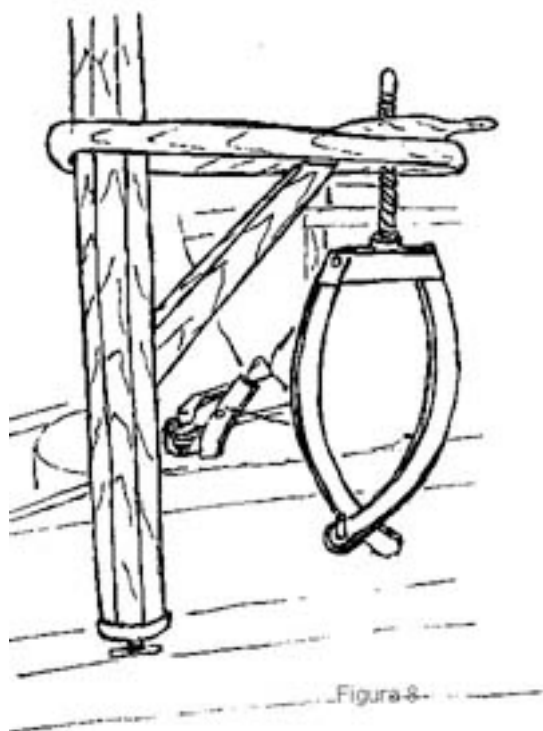
Fig. 8: Cabria, burru o guindastre para levantar la muela.
